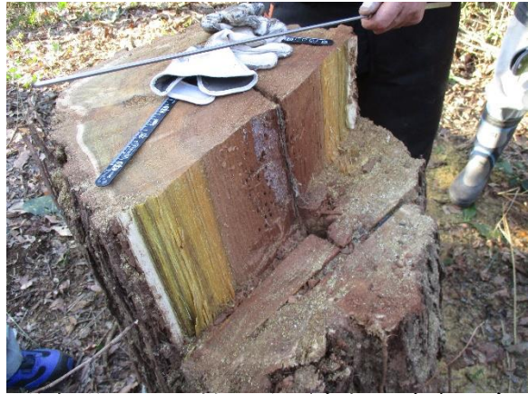
伐倒後の切り株見分（内部の変色・亀裂 弦の厚さ分布と倒れ方向との議論）
