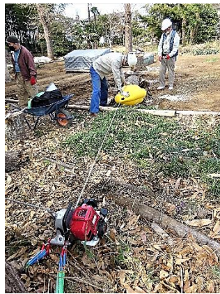
クヌギの伐倒 右上の写真：ポータブルロープウインチを使って伐倒木を移動
