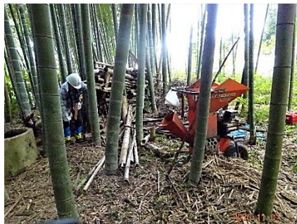
チップパーを使い廃材の処理
