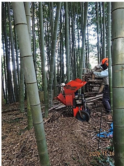
チップパーを使い廃材の処理
